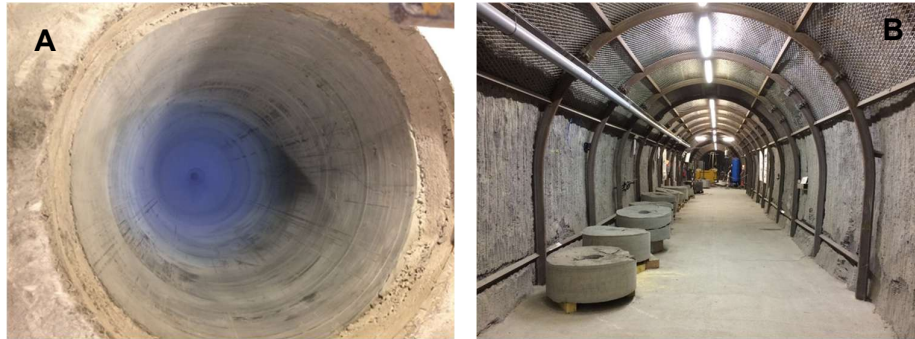
Figure 5. A. Puit vertical, 1 mètre de diamètre et 10 mètres de long. B. Carottes extraites du puits et entreposées dans une des galeries annexes du laboratoire.
